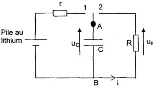
La valeur de r est très faible, de telle sorte que le condensateur se charge très rapidement lorsque l'interrupteur (en réalité un dispositif électronique) est en position 1. Lorsque la charge est terminée, l'interrupteur bascule en position 2. Le condensateur se décharge lentement dans la résistance R, de valeur élevée.
