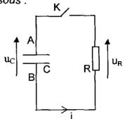
On enregistre alors l'évolution de la tension u<sub>C</sub> aux bornes du condensateur. La courbe obtenue est fournie sur l'ANNEXE N°2 À RENDRE AVEC LA COPIE.
