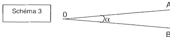
On montre que pour des points à l'infini et un instrument dont le diamètre de l'objectif est D, la limite de résolution, exprimée en radians, pour une lumière de longueur d'onde  $\lambda$  (en mètres) vaut  $\alpha = \frac{1,22 \lambda}{D}$ .
