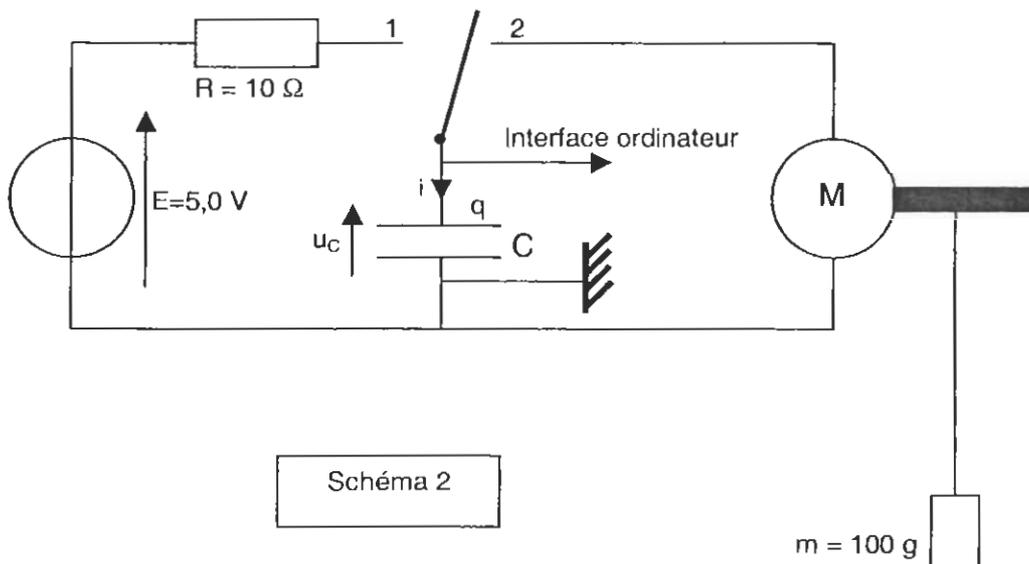
Le schéma précise le sens positif du courant, la définition des tensions  $E$  et  $u_C$  et l'armature du condensateur portant la charge  $q(t)$ .
