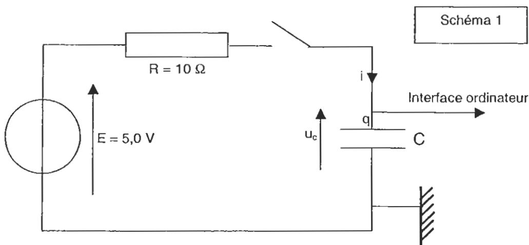
L'ensemble RC est attaqué par un générateur de tension  $E = 5,0 \text{ V}$ .
