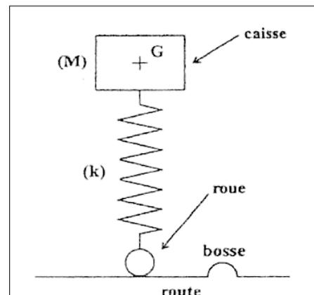
1. On considère la caisse de la Logan de masse  $M = 1\,095\text{ kg}$  à l'arrêt, sans passager. Le ressort est alors comprimé. On appelle  $|\Delta \ell_0|$  la valeur absolue de la différence entre sa longueur à vide et sa longueur en charge.
