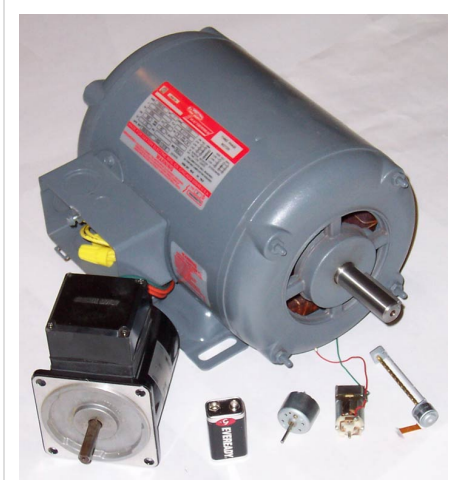
Différents types de moteurs (la pile 9 V sert de référence d'échelle)
