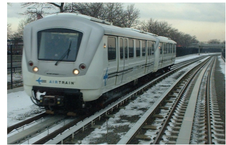
Les trains ART de Bombardier se déplacent grâce à la bande d'aluminium que l'on voit entre les voies
