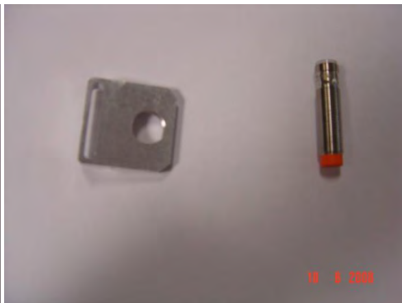
Nouveau support et détecteur
