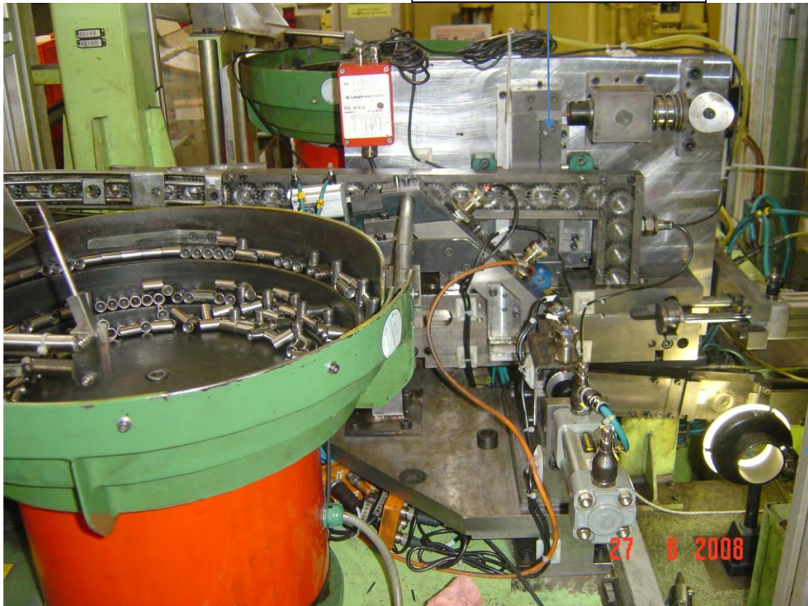
Rampe verticale avec chicane
